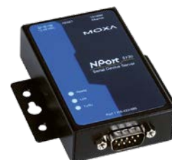
Interface converter SU 02 RS 485 <-> Ethernet
